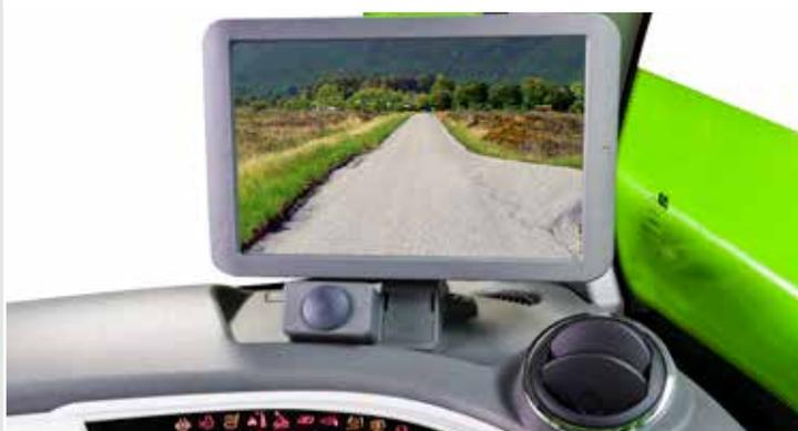
En combinaison avec le tableau de bord 10,1" du système ASCS, il est possible d'équiper la machine d'une caméra arrière à activation automatique, avec l'activation de la commande de marche arrière. Les images provenant de l'arrière du chariot télescopique sont affichées directement sur le tableau de bord de la cabine.
