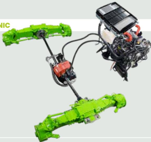
La transmission intelligente à variation continue Merlo CVTronic combine les avantages des transmissions hydrostatiques avec la performance et l'efficacité d'une transmission CVT. Par rapport à une transmission hydrostatique classique, le CVTronic assure :
