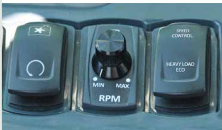
Les modèles de la gamme « chariots télescopiques capacité moyenne » sont enrichis du système de réglage et de maintien de la vitesse de croisière appelé Speed Control. Cet outil permet à l'opérateur de sélectionner une vitesse de transfert souhaitée et, une fois le Speed Control activé, la machine fonctionnera pour maintenir une vitesse constante sans avoir besoin d'une autre intervention. En appuyant sur la pédale de frein ou sur le sélecteur de sens de marche, la machine arrêtera d'avancer.
