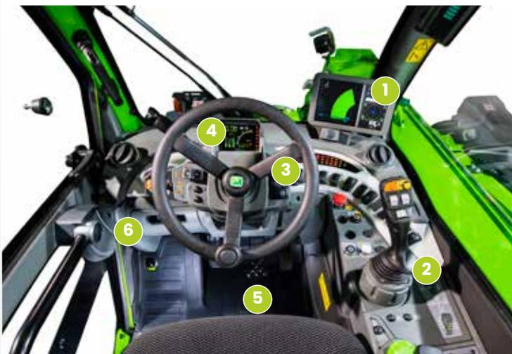
Une nouvelle conception privilégie la fonctionnalité et le confort ; les informations et les commandes des différents systèmes et dispositifs sont regroupées pour maximiser l'ergonomie. L'inverseur au volant est également dupliqué sur le joystick.
