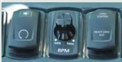
proportionnellement à l'utilisation du joystick (plus l'inclinaison du joystick est grande, plus le régime moteur est élevé). Cette fonction vous permet d'optimiser davantage la consommation de la machine, permettant de maintenir le ralenti plus longtemps et, en même temps, de maximiser la réactivité pour la manipulation de matériaux.
