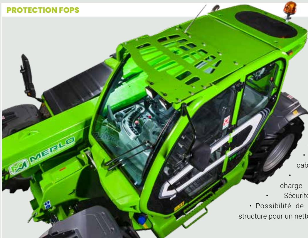
Une structure métallique, placée sur le toit en verre, permet d'atteindre le niveau de certification le plus strict en matière de protection : FOPS de niveau II. Cette reconnaissance constitue une garantie en termes de :
